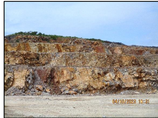
ภาพที่ 2.6 การเปิดหน้าเหมืองแบบขั้นบันได
