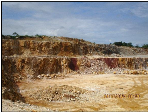
ภาพที่ 2.6 การเปิดหน้าเหมืองแบบขั้นบันได
