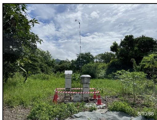
ภาพที่ 3.5 การตรวจวัดคุณภาพอากาศ บริเวณบ้านหนองมะค่า
