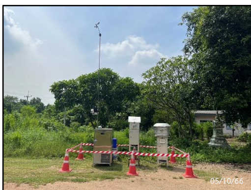
ภาพที่ 3.4 การตรวจวัดคุณภาพอากาศ บริเวณบ้านวังกวาง (บ้านที่อยู่ใกล้ หน้าเหมืองหรือจุดระเบิดมากที่สุด)
